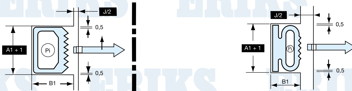
Interne radiale expansie (opstelling II) De werkdruk P_i is 20 tot 30% hoger dan de normale druk.
